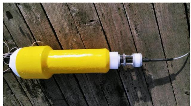
Плавучесть корректируется с учетом полезной нагрузки и ожидаемых условий волны, путем изменения количества сложенных в хвостовом отсеке грузов. Большие размеры корпуса доступны для поддержки больших полезных нагрузок и / или более глубоких мест стоянки, а также более динамичных условий окружающей среды.
